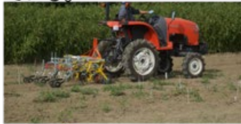
除草機(右)とカンゾウ収穫機(左 特許出願中) 農研機構と共同開発
